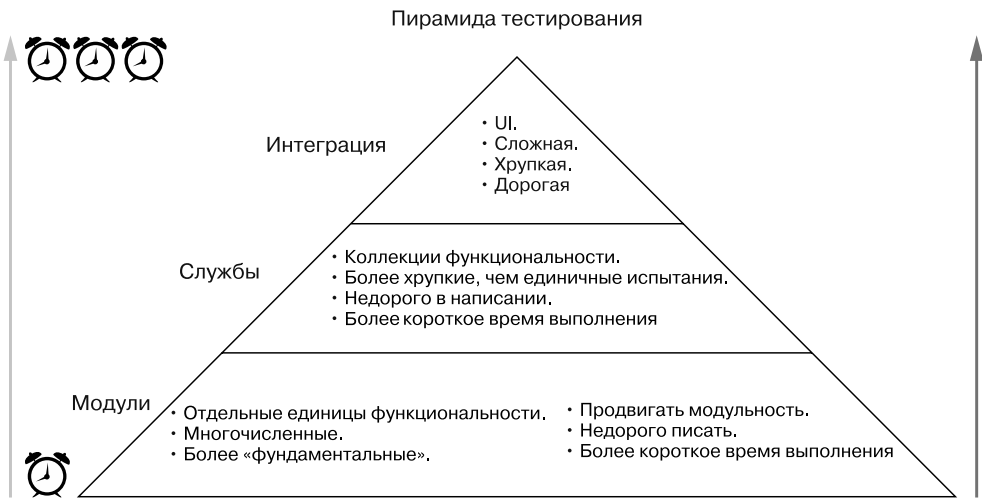
Рис. 9.1. Пирамида тестирования — это способ определения количества и типов тестов, которые вы пишете при тестировании своих приложений. Обратите внимание на то, что некоторые типы тестов занимают больше времени, а следовательно, более затратны с точки зрения времени (и финансов)
