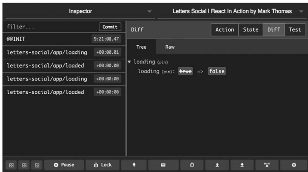
Рис. 10.5. Когда приложение будет запущено, выполненное вами хранилище примеров получит результаты работы создателей действия и отправит их в хранилище. Прямо сейчас у вас нет функционирующих редукторов, так что почти ничего не произойдет. После того как вы настроите редукторы, Redux определит, какие изменения следует выполнить в зависимости от того, какой тип действия отправлен
