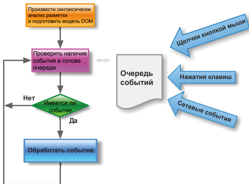
Рис. 3.2. Упрощенное представление процесса обработки, организуемого в цикле ожидания событий в браузере, где каждое событие обрабатывается по очереди в одном потоке
