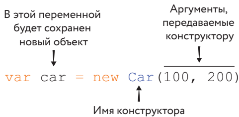
Рис. 12.1. Синтаксис вызова конструктора с именем Car и двумя аргументами
