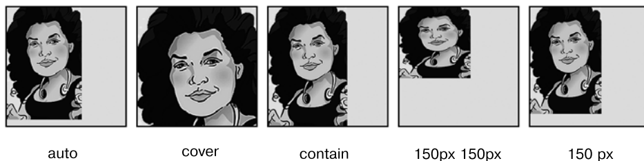
Рис. 9.10. Свойство background-size , имеющее значения auto , cover , contain и числовые значения длины (при установке background-repeat: no-repeat )
