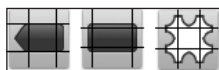
Рис. 11.2. Небольшие изображения, которые делятся на части для создания эффектов границы и фона на элементах различных размеров
