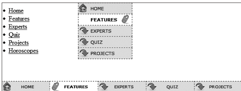
Рис. 9.4. Используя CSS, вы можете превратить обычные теги <ul> в то, что захочется, например в вертикальное или горизонтальное управляющее меню (панель навигации)
