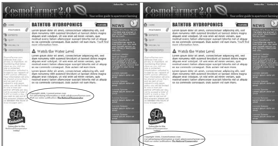
Рис. 13.6. Нижний колонтитул должен оставаться внизу страницы, независимо от перемещаемых элементов. Чтобы добиться этого, используйте свойство clear
