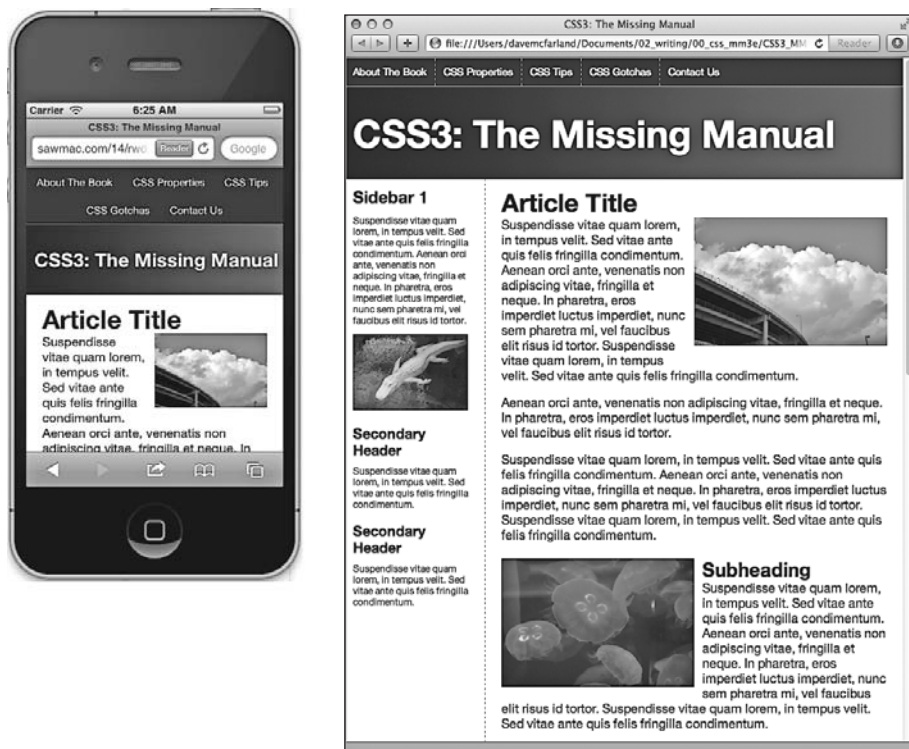
Рис. 14.9. Благодаря адаптивному дизайну отдельную веб-страницу можно преобразовать так, чтобы она наилучшим образом помещалась на устройстве с любой шириной экрана
