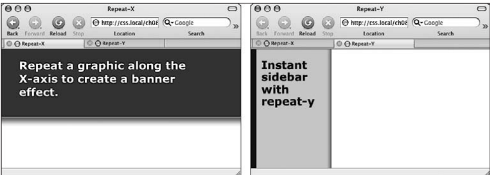
Рис. 8.4. Пользуясь возможностью управления повтором фоновых изображений, можно создать графический фон для заголовков ( слева ) и боковых панелей ( справа ) веб-страницы
