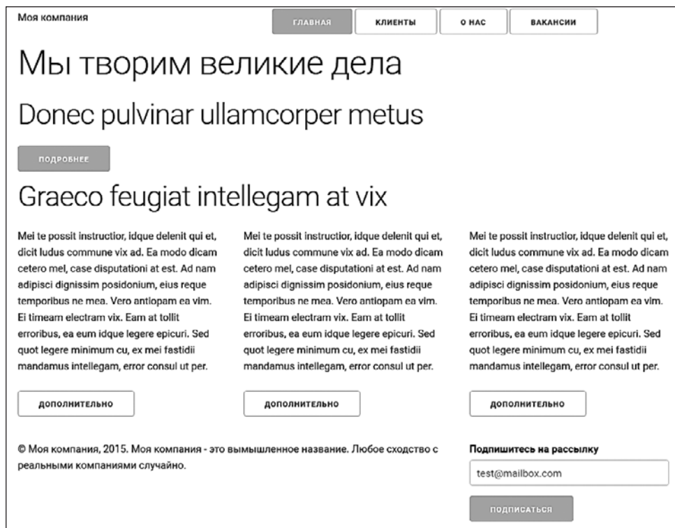
Рис. 16.7. С помощью правильно структурированного HTML-кода, нескольких имен классов и CSS-файла системы модульной верстки Skeleton легко создавать многоколоночные дизайны страниц
