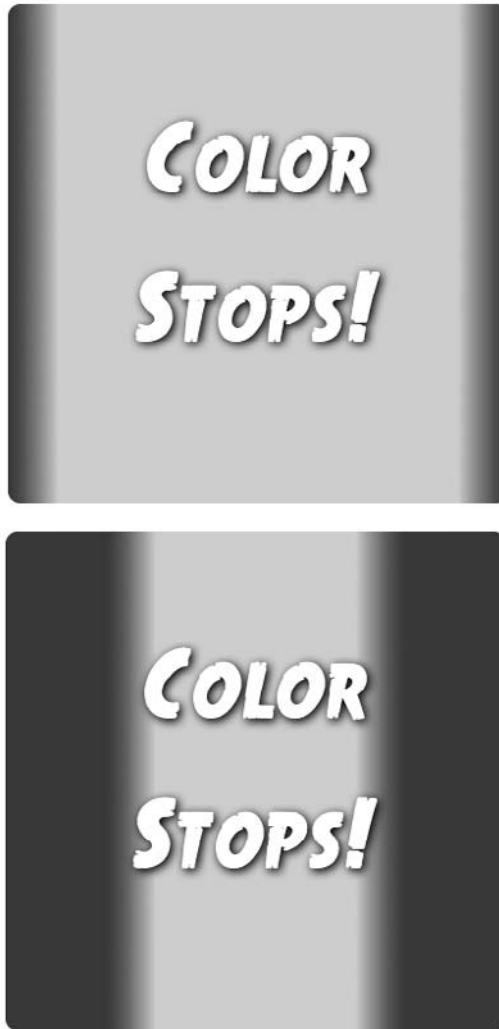
Рис. 8.16. Область появления цветового узла на градиенте можно указать вполне конкретно. В верхнем примере к 10 % ширины элемента слева направо темно-красный цвет переходит в оранжевый
