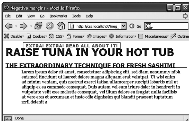
Рис. 7.5. Чтобы превратить верхнюю границу последнего абзаца в нижнюю границу вышестоящего заголовка, вернее, имитировать такой эффект, добавим небольшой отступ. Верхний отступ шириной 5 пикселей сместит абзац вниз относительно границы, в то время как левый отступ шириной 4 ем сместит текст абзаца, оставив верхнюю границу у левого края
