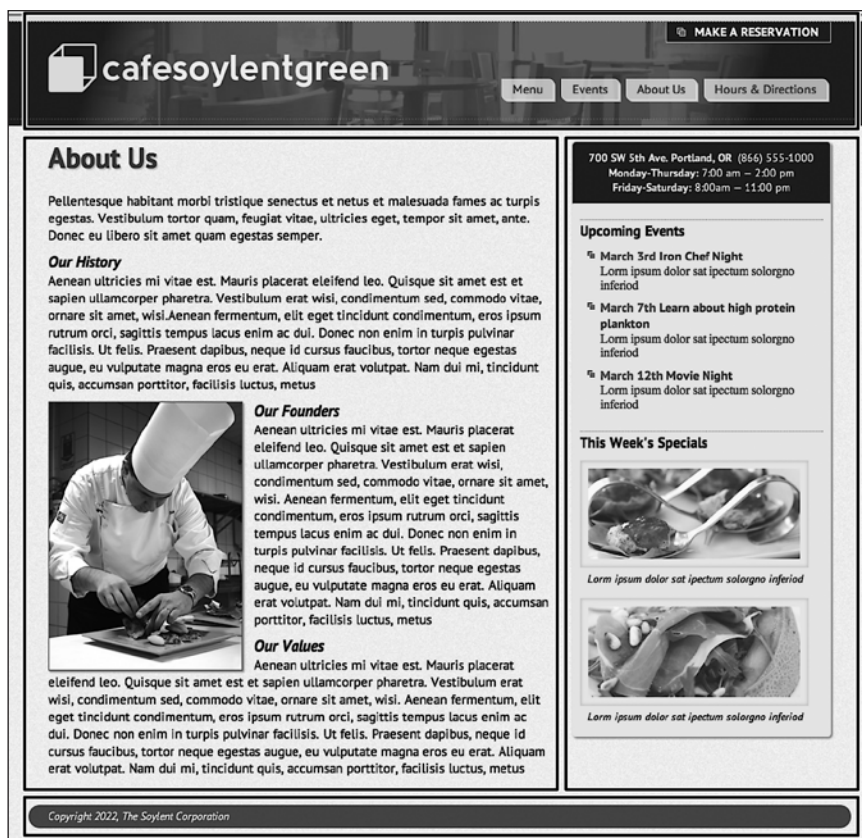
Рис. 1.3. Стандартный двухколоночный макет страницы, включающий такие основные структурные блоки, как баннер (в верхней части), колонка основного содержимого (слева по центру), боковая панель (справа по центру) и нижний колонтитул (в нижней части)
