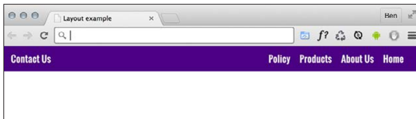
Рис. 4.4. Изменение визуального порядка с помощью Flexbox
