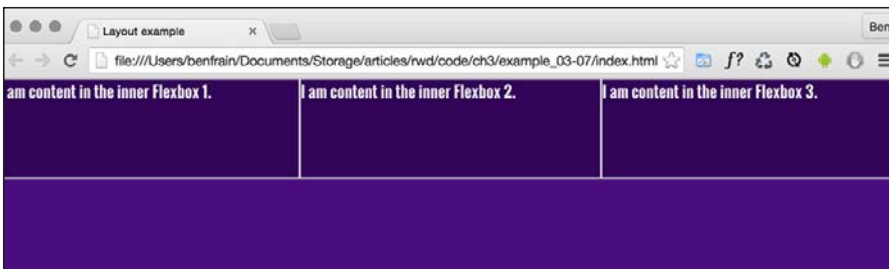
Рис. 4.13. При одинаковых значениях гибкости все контейнеры имеют одинаковый размер
